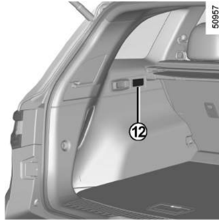
چراغ‌های محفظه بار وقتی درب پشتی باز شود چراغ 12 روشن می‌شود.
