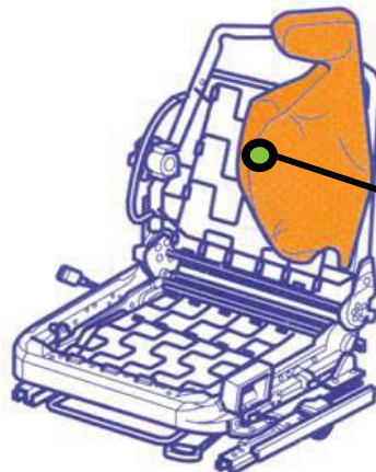
Lateral Airbag Module ( 12 Liter Capacity ) ایربگ جانبی ( با ظرفیت ۱۲ لیتر )
