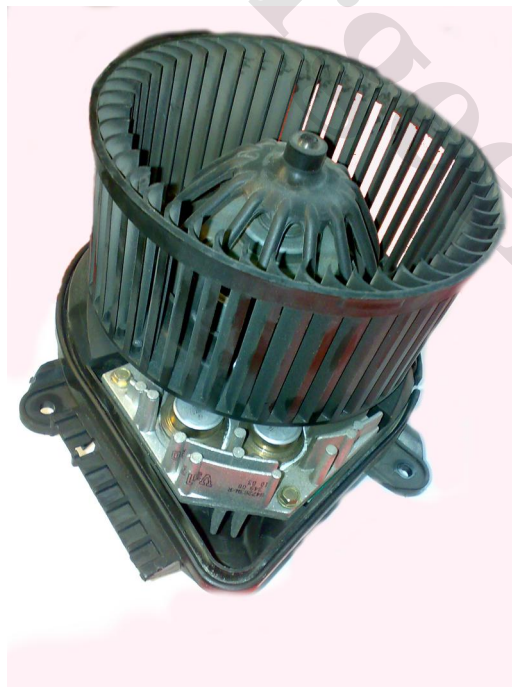
شکل 3-8 موتور فن بخاری مدول نصب شده بر روی آن
