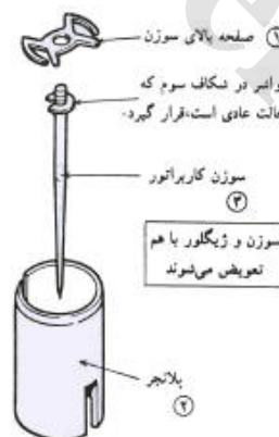
درپوش کاربراتور دو زاویه دارد که در شیار بدنه مربوط قرار می گیرد.
