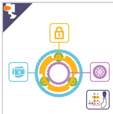
شکل ۱۱. قطعاتی که امکان انتقال حرکت را از شفت ورودی به شفت خروجی فراهم می‌آورند.
