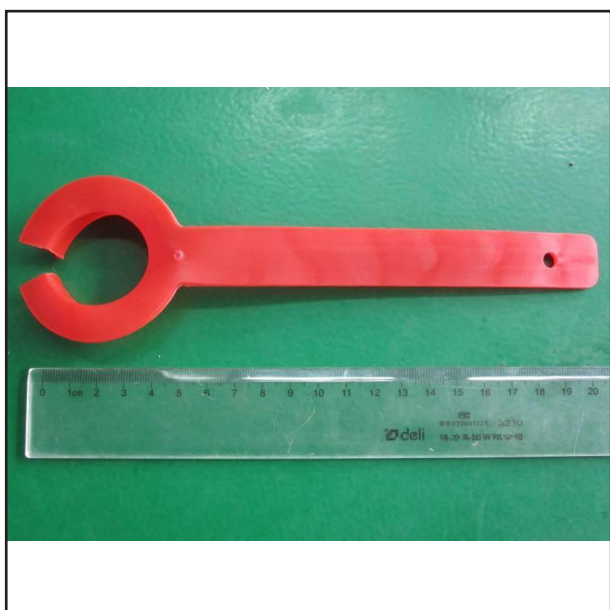
ابزار محافظ برای نصب پلوس - شماره سریال 102980 توجه: تصاویر ممکن است با قطعه اصلی تفاوت داشته باشد.
