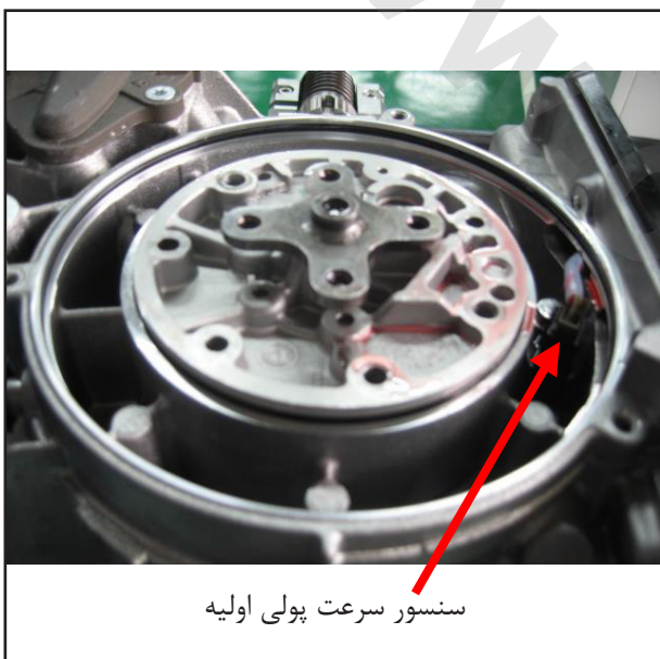
از ابزار دم باریک برای جدا کردن کانکتور استفاده کنید
