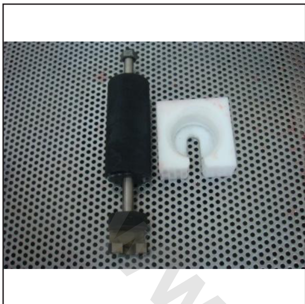
ابزار خارج کننده پمپ روغن گیربکس - شماره سریال 102977
