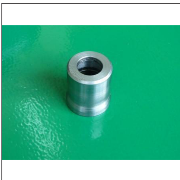
ابزار راهنمای جا زدن کاسه نمد شفت ورودی - شماره سریال 102971
