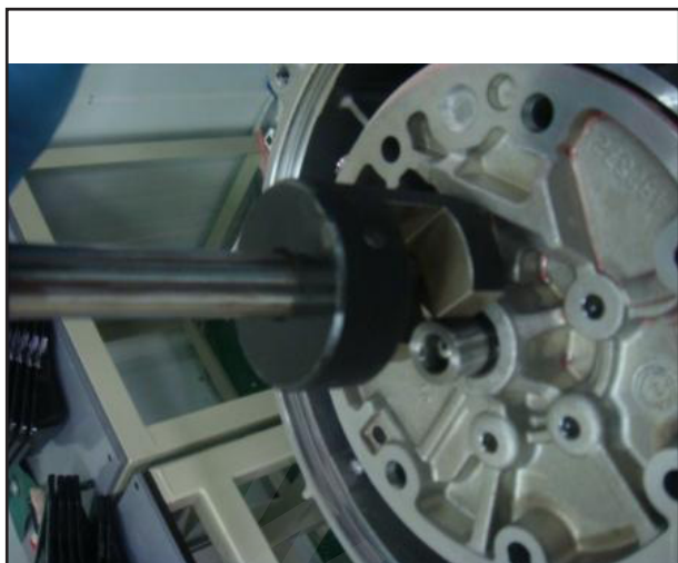
۶ عدد پیچ اویل پمپ را باز نموده و ابزار مخصوص 102977 را نصب کنید
