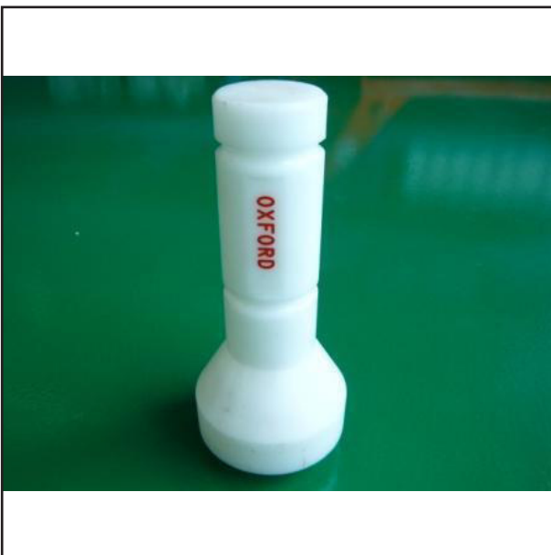
ابزار جازدن کاسه نمد دیفرانسیل - شماره سریال 102979
