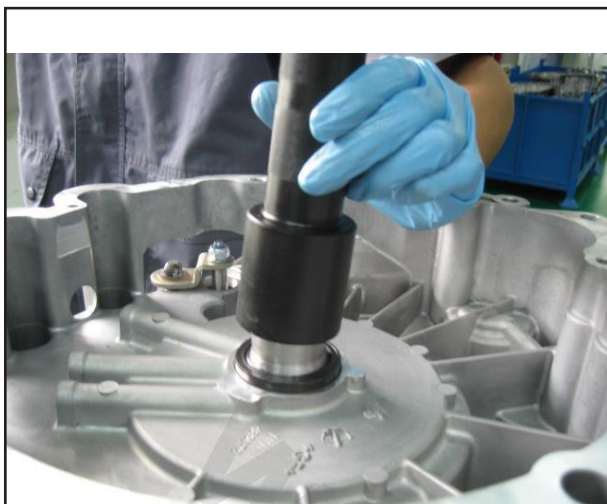
نصب کاسه نمد به وسیله ابزار جازدن کاسه نمد شفت ورودی 102972
