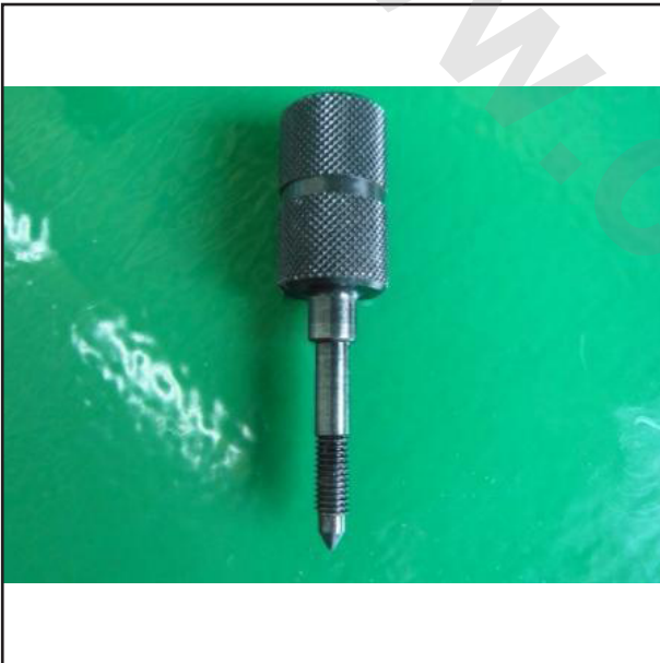
ابزار همراستا کردن برای نصب بلوک هیدرولیک - شماره سریال 102978
