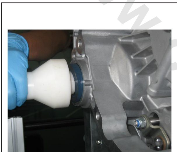
نصب کاسه نمد جدید به وسیله ابزار مخصوص
