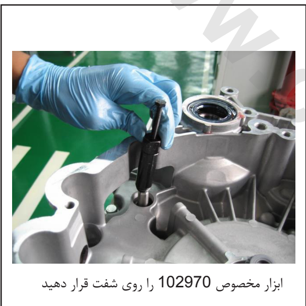
نصب کاسه نمد به وسیله ابزار جازدن کاسه نمد شفت ورودی 102972
